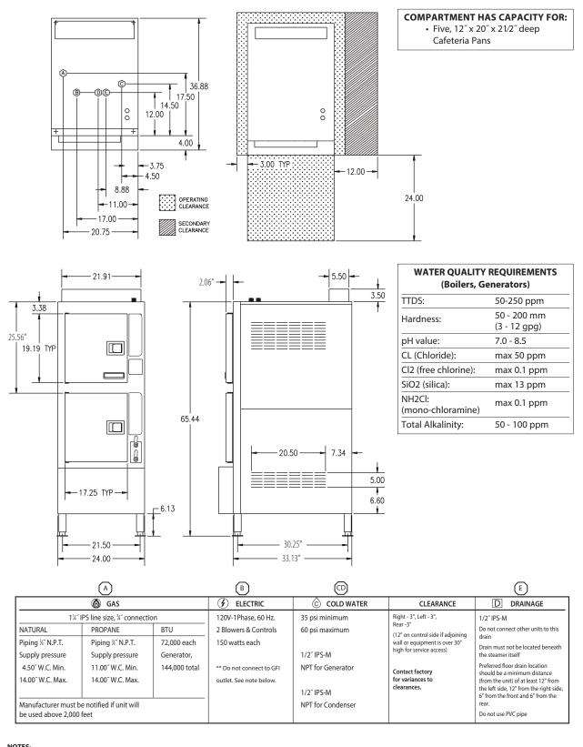
\*\*DO NOT CONNECT TO GFI OUTLET. CLEVELAND RANGE RECOMENTS GAS FIRED 120 VOLT STEAMERS BE HARD WIRED DIRECTLY TO ELECTRICAL SYSTEM.
