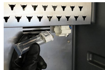
7. Retirez l'ancienne ampoule UVC avec précaution puis insérez délicatement l'ampoule UVC de remplacement. Ne retirez pas la protection extérieure en plastique de l'ampoule UVC de remplacement.
